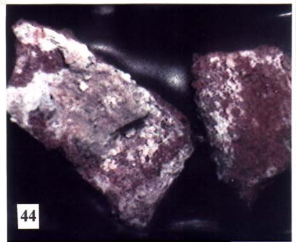
Abb.40: Probennahmestelle CH 2/16: Ziegel mit Tüncheresten ohne Algenbewuchs (Konversensaal, O-Wand, oberhalb der intensiv bewachsenen Fläche)
